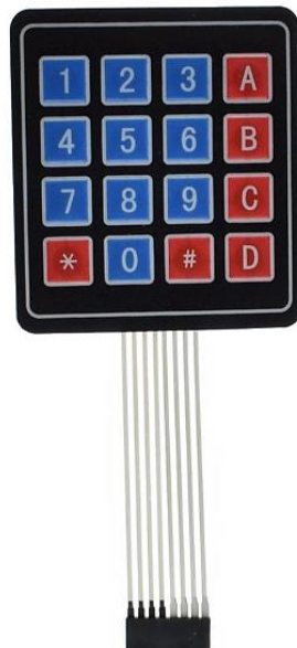
Clavier à membrane de matrice 4*4
