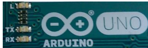
Figure 38 : Les trois LED lumineuses de la carte Uno
