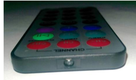
LED IR à l'entête d'une télécommande IR
