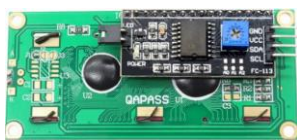
Afficheur LCD 16*02 avec interface I2C 3 broches
