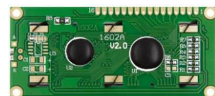
Afficheur LCD 16*02 avec interface standard 16 broches
