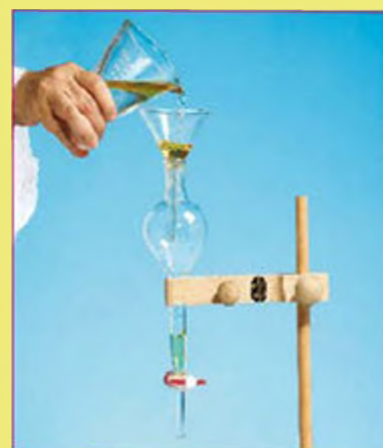
Fig. 3 Séparation par décantation
