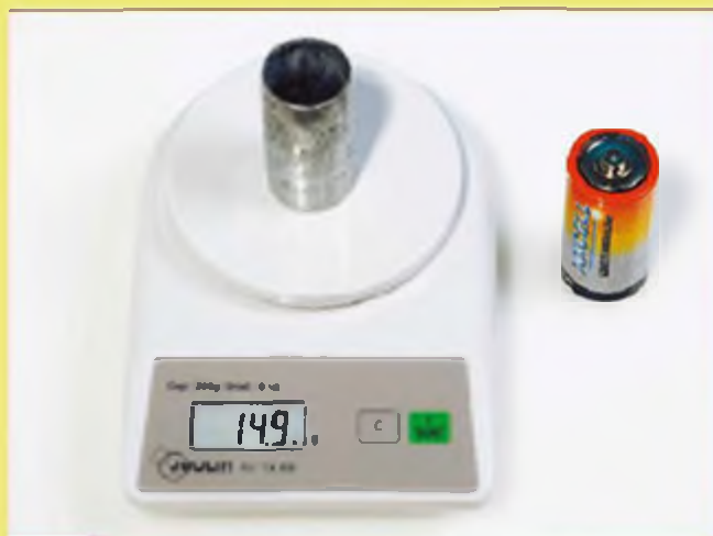
Fig. 1 Masse du cylindre de la pile neuve
