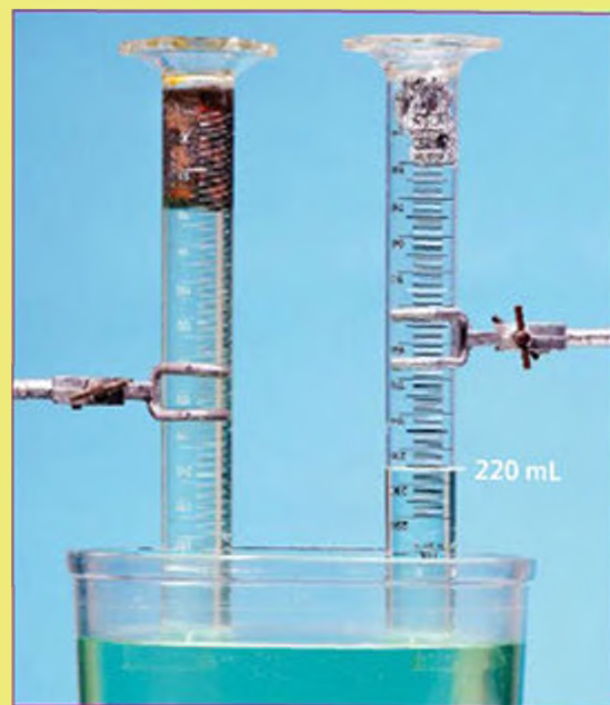
Fig. 2 Éprouvettes contenant du fer et de l'aluminium après plusieurs jours
