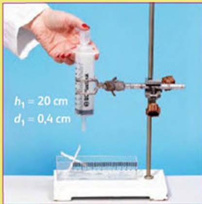
Fig. 1 Chute d'eau d'une hauteur h_1
